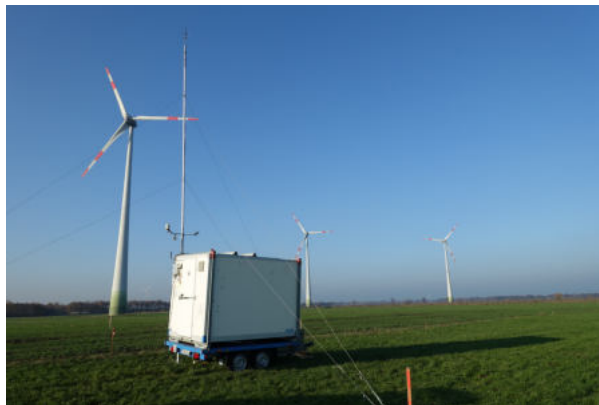
Abbildung 29: Mobiler Messcontainer und mit Sensoren ausgestatteter Messmast zur Erfassung meteorologischer Daten
