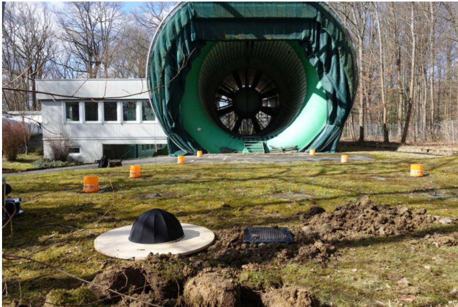
Abbildung 32: Messaufbau mit zwei verschiedenen Messpositionen der Infraschallmikrofone im Windkanal der Universität Stuttgart zur Erprobung der Infraschallmessverfahren
