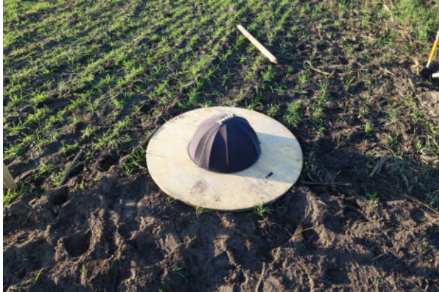
Abbildung 30: Platzierung des Mikrofons auf einer schallharten Platte mit einem sekundären Windschirm
