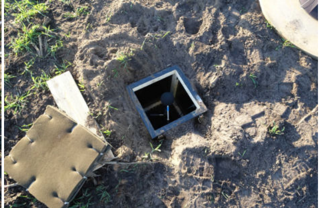
Abbildung 31: Platzierung des Mikrofons auf einem Stativ in der Kiste vergraben im Erdboden
