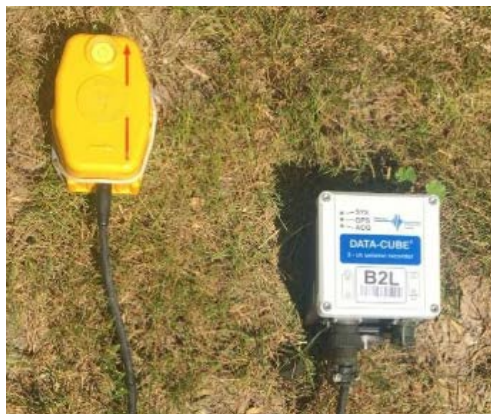
Abbildung 2: Messgerät, bestehend aus dem Sensor (links) und dem Datenlogger (rechts). Die Ankopplung erfolgt über einen Erdspeiß. Quelle: Lerbs et al. (2020)
